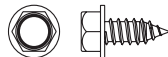
M x 48 #14 x 5/8" HEX HEAD SHEET METAL SCREW TORNILLO AUTORROSCANTE DE CABEZA HEXAGONAL #14 x 5/8" VIS À TÔLE, TÊTE HEXAGONALE N° 14 x 5/8 PO
