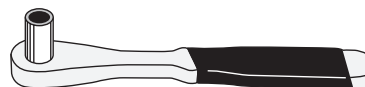
7/16", 1/2" Socket on Ratchet Trinquete con casquillo de 7/16, 1/2 pulg. Douille de 7/16, 1/2 sur cliquet
